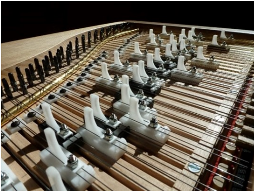
Görsel 12 Fluid piyanodaki mikrotonal ayar mekanizmaları
